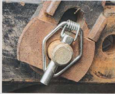
Höchstes Maß an Sicherheit: Der Klappsplint nach dem System Claas.
