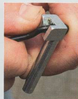
Alternativ muss der Bügel mit der Hand aus der Nut gezogen werden, das ist im Vergleich nicht einfach.
