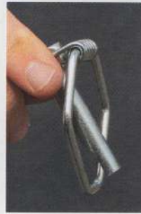
Der Bügel ist frei pendelnd in dem Federpaket eingelassen. Das Paket kann ungewollt „hochschnappen“.
