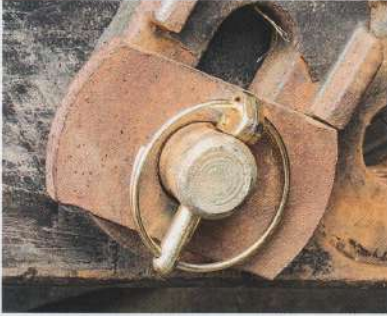
Sicher, aber fummelig: Der Splint aus dem Ersatzteillager bei John Deere.
