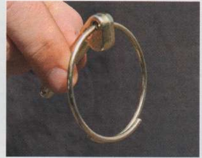
Der Ring ist frei in der oberen Bohrung angebracht. Hier schnappt nichts zu.
