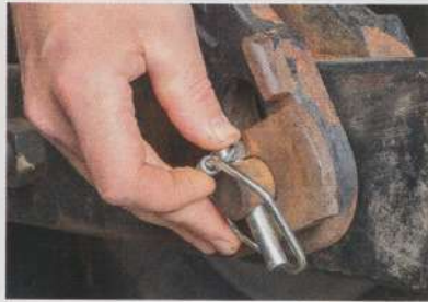
Das Federpaket wird mit dem Bügel heruntergedrückt und der Bügel vor dem Schließen hinter den Schaft gedrückt.
