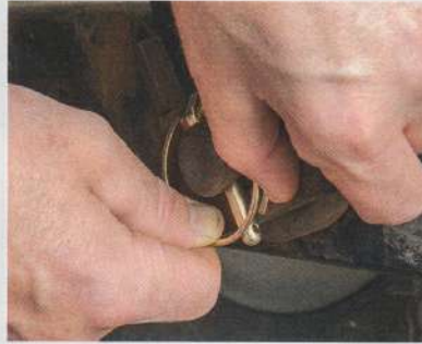
Der Drahtbügel muss auseinander gedrückt und dann ins Loch gedreht werden.
