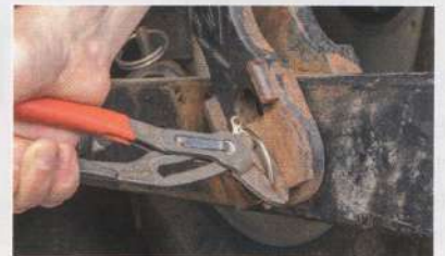
Die Rastung des Rübiger-Sicherheitssteckers ist mit bloßer Hand kaum zu lösen. Da ist Hilfswerkzeug nötig – lästig.
