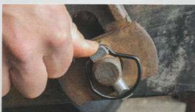
Passt der Splint zum Bolzen, entriegelt sich der Federling aus der Nut im Schaft.
