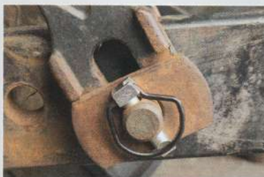
Der Splint sichert über den Federling, der in einer Nut im Schaftkopf eingelassen ist.
