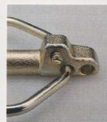
Das Loch zur Befestigung einer Kette oder ähnlichem oben am Schaft macht Sinn. Die Ketten dürfen nämlich nicht mit dem Federling verbunden werden.
